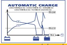
Recharge les batteries au plomb à électrolyte liquide à 100 % (Courbe W2) les batteries de 40 à 350Ah.
