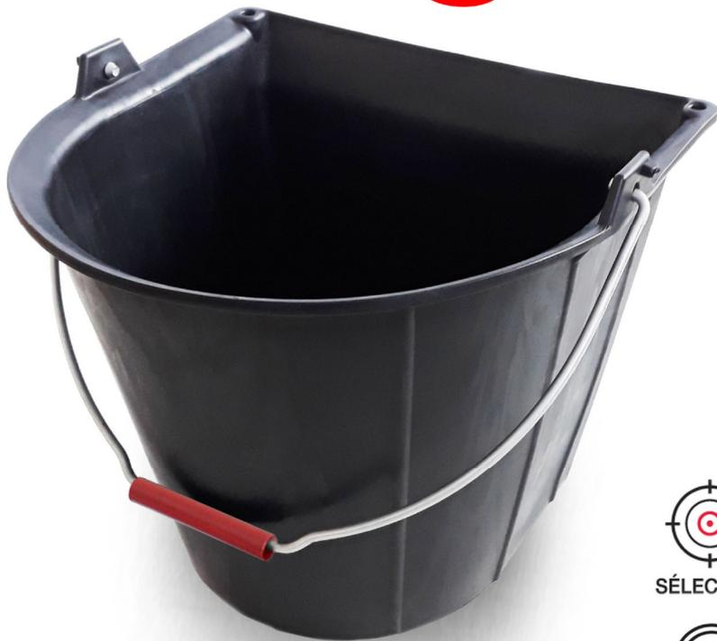
Seau caoutchouc synthétique (EPDM) **polyvalent, très robuste et léger, résistant aux chocs et à tous types d'agression.** Graduation moulée. Parois avec nervures de renfort. Anse diamètre 5,3mm avec poignée de confort Ø 14mm fixée par bouterollage (résistance des oreilles jusqu'à 80 kg).
