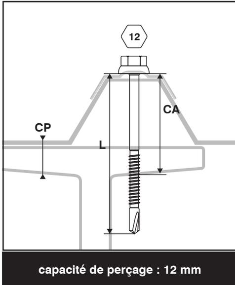
capacité de perçage : 12 mm
