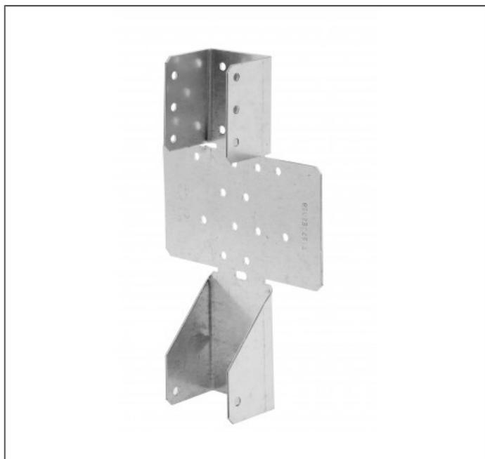
Le sabot à pente réglable SPR permet la fixation de chevrons sur support bois et béton. Le réglage de la pente est fait sur le chantier pour des pentes de toiture jusqu'à 45° vers le bas ou le haut. Ce réglage est à effectuer une seule fois dans le sens de la pente souhaitée.
