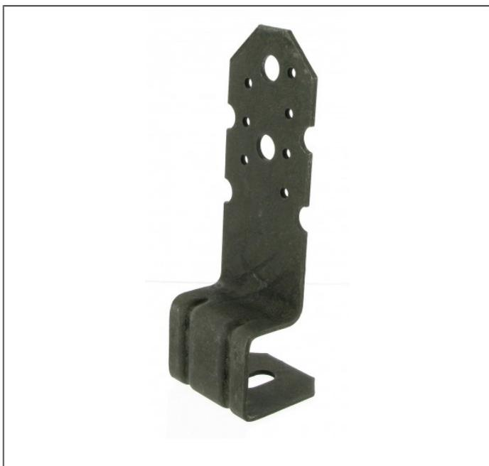
Le pied de poteau PBP60/50 est préconisé pour la réalisation d'ouvrages de type pergola. Il offre une grande polyvalence dans sa mise en oeuvre. Il s'utilise par paire pour des sections de poteaux carrés de 70 à 150 mm. Pour des sections plus importantes (250 x 250 maximum), l'utilisation de quatre pieds par poteau est préconisée.
