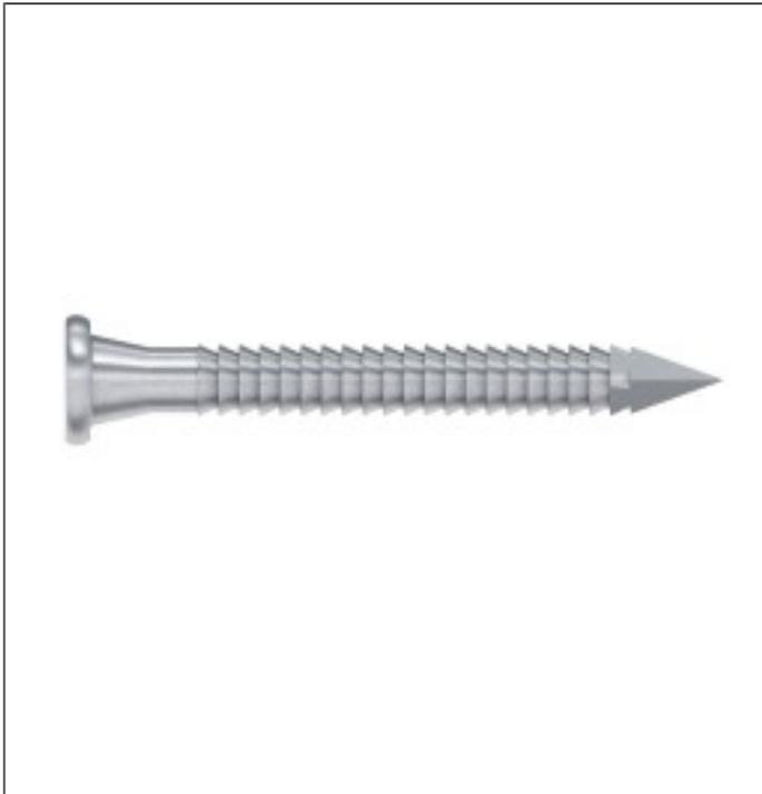
Les pointes annelées électrozinguées CNA sont préconisées pour les assemblages structurels des connecteurs Simpson Strong-Tie. Tous nos essais ont été réalisés avec ce type de pointes. Pour plus de traçabilité sur les chantiers, elles sont estampillées  $\neq$ , une garantie de qualité sans équivalent.
