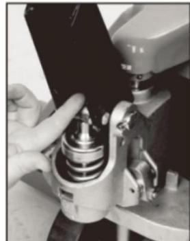
3.10 Des deux mains, appuyer sur la came pour relever le crochet à l'intérieur du corps, et faire passer l'extrémité de la chaîne dans la came.
