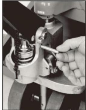
3.8 Faire d'abord passer la chaîne et l'écrou à l'intérieur du timon, À TRAVERS le trou central de l'axe de la poignée.
