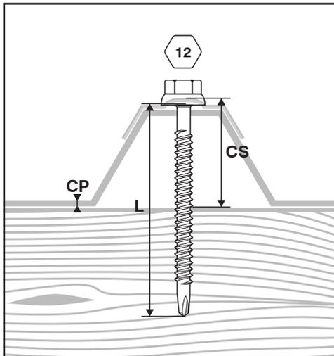
capacité de perçage : 4x0,75 mm
